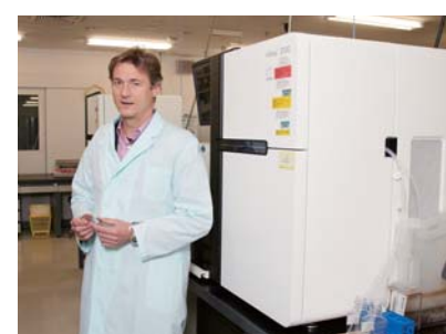
高速・低コストで膨大な塩基配列を読み取る遺伝子解析装置（シーケンサー）。
