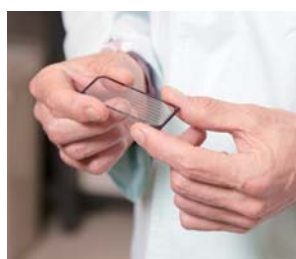
フローセルと呼ばれる特殊なガラス板。これにサンプル液を流して遺伝子を解析する。
