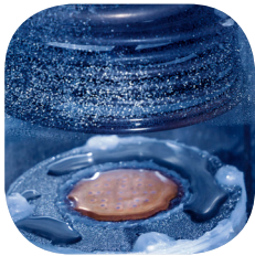
水を使った熱移動ではアルミが腐食するが、エタノールは腐食を起こさない
